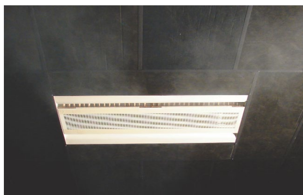
Ensayo en Laboratorio Koolair. Orientación de la vena de aire en V
