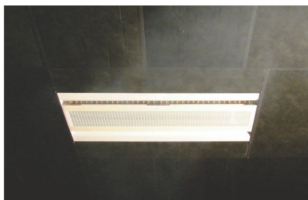
Ensayo en Laboratorio Koolair. Desviación de la vena de aire 45°
